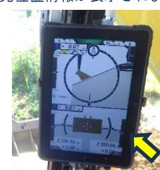
【バックホウマシンガイダンス】とは、GNSSなどの位置計測装置を用いて建設機械の位置情報を計測し、施工箇所の設計データと現地盤データとの差分をオペレータへ提供する操作補助システムです。これにより丁張作業が不要となり、施工法面全体の管理が可能となり、私たちの現場管理業務も簡素化されました。また、測量作業員と重機の近接作業が排除され、重機から降りての確認作業等の必要が無くなったことから、他稼働重機との接触および重機昇降時の転倒などの災害リスクも低減され安全性向上にも大変効果があり、現場では大活躍しています！
